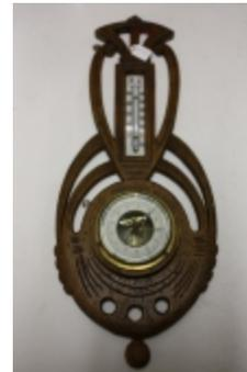
baromètre anéroïde avec thermomètre
